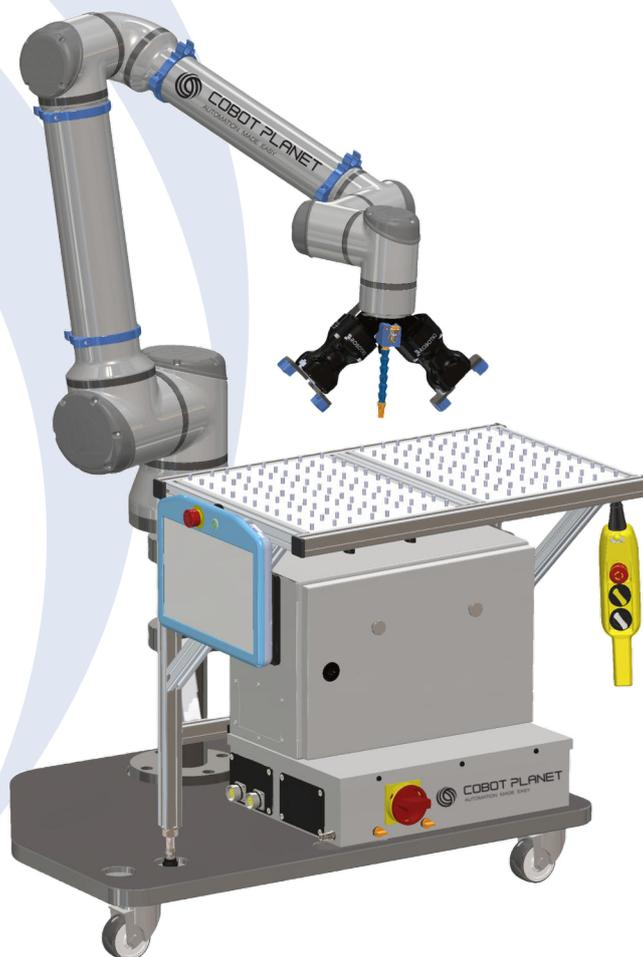
Aus dieser Kombination entsteht eine mobile Station zum Einspannen des Halbzeugs in das Maschinenfutter, zum Ausblasen der Späne mit Druckluft und zum Lagern des fertigen Werkstücks. Sie ist ideal für die Bedienung von Fräsmaschinen und Revolverdrehmaschinen. Die COBOX-Station ist mit den meisten auf dem Markt befindlichen Steuerungen kompatibel.
